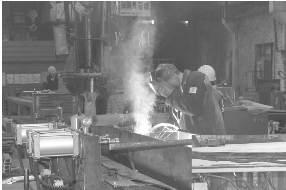
Установка литья на втором стенде сборки хребтовой балки
